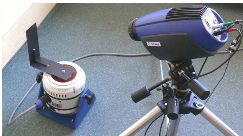
Rys.2. Kamera termowizyjna do bezdotykowego pomiaru naprężeń na powierzchni płyt.
